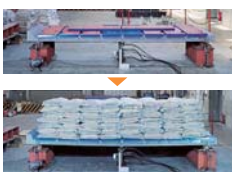
屋根パネルの強度実験（一般地域用の標準厚さ15cmを使用）
